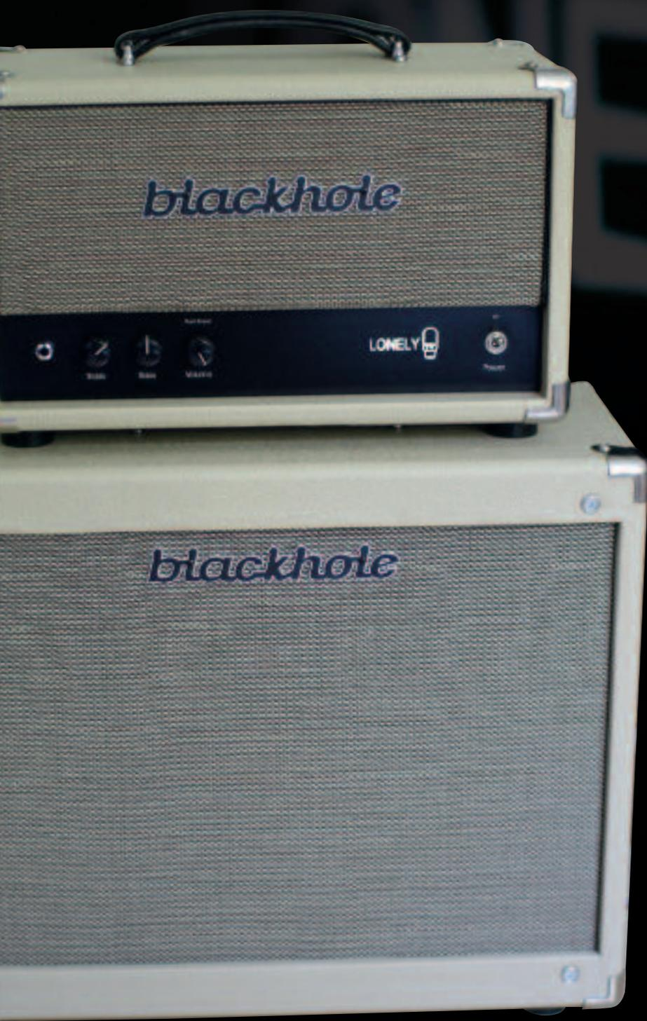
Verstärker mit variabler Röhrenbestückung sind am Markt lange etabliert – Blackholeamp kombiniert die Flexibilität verschiedener Vor- und Endstufenröhren mit den dynamischen Klangeigenschaften großer Trafos. Das Ergebnis: Volles Klangbild ohne die „überzüchteten“ Höhen mancher Boutique-Amps. Als Vorstufe kann auch eine 6SL7-Röhre, bei alten Gibson- oder Ampeg-Verstärkern verbaut, eingesetzt werden – bislang ein Novum unter „Röhrentausch“-Amps.
